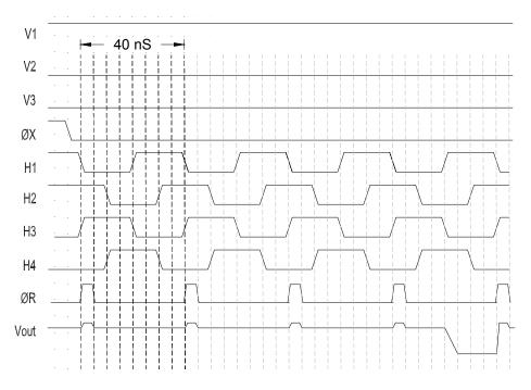
CCD 545 HORIZONTAL CLOCK TIMING
